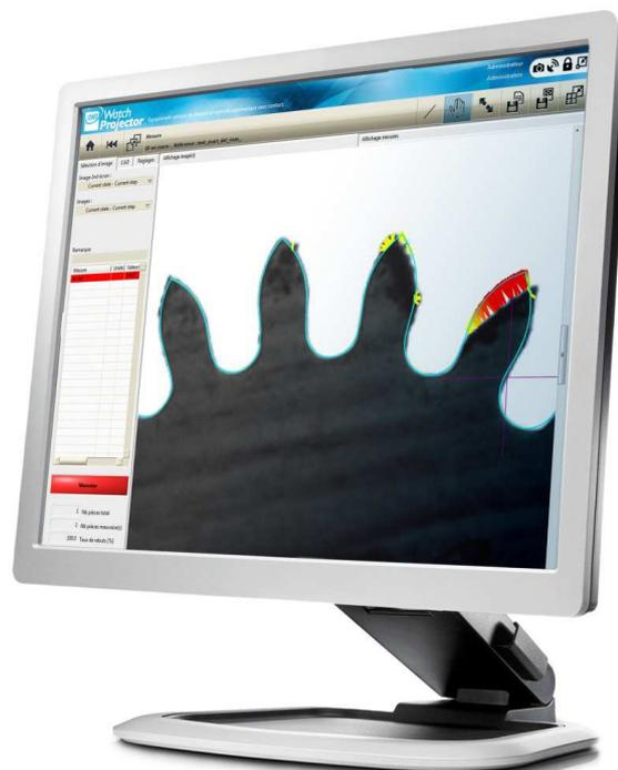
*Le contrôle qualité automatisé (ici un contrôle optique) permet notamment de mesurer instantanément l'écart entre la valeur théorique du plan et la valeur réelle de la pièce sur l'ensemble du contour. Dans le cas ci-dessus, les écarts (défauts) sont signalés par un dégradé jaune-rouge. La décision (pièce bonne ou mauvaise) est prise automatiquement en fonction des tolérances paramétrées.*
