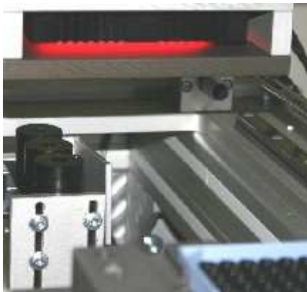
9 Qualitätskontrolle von gespritzten Medizinalteilen aus Kunststoff
