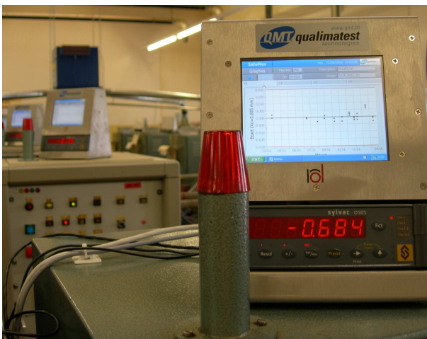
9 Qualitätskontrolle von gespritzten Medizinalteilen aus Kunststoff
