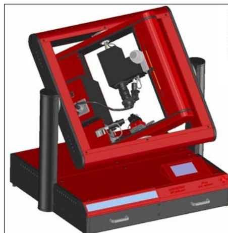
Fig. 13 : Vue générale du système motorisé pour la mesure dans toutes les positions
