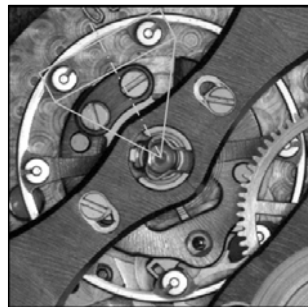
Fig. 3 : Pleine image du balancier 3120, avec zone de traitement partiel des masselottes
