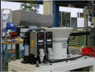
Automatische Teilezuführung mit Wendelförderer
